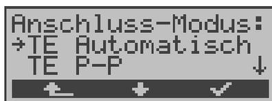
Wählen Sie mit Hilfe der ↓ ↑-Tasten oder mit dem mittleren Softkey < ↓ > den gewünschten Anschluss-Modus aus.
