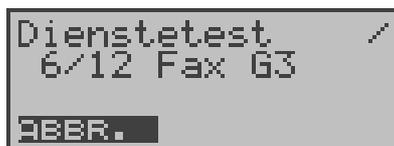
Während des Testlaufs beschreibt ARGUS die ersten drei Displayzeilen in Abhängigkeit vom gerade aktuellen Testpunkt. Bei Abbruch des Testlaufs ( Softkey < ABBR.> ) öffnet sich ein weiteres Menü:
