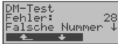
Im Beispiel ist ein Fehler mit dem Code 28 aufgetreten. Der Fehler gehört zur Fehlerklasse "falsche oder ungültige Nummer".
