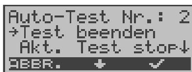
In diesem Menü haben Sie die Möglichkeit, den laufenden Test vollständig abubrechen oder aber einzelne Testpunkte (z.B.Dienstetest) zu überspringen.
