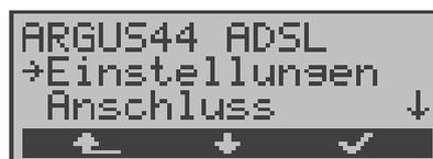
Mit **<  $\checkmark$  >** öffnen Sie das mit  $\rightarrow$  gekennzeichnete Menü (im Beispiel *Einstellungen*).
