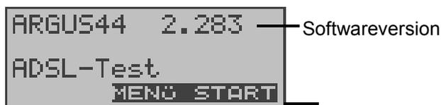
Es wird die aktuelle Belegung der drei darunterliegenden Softkeys angezeigt.
